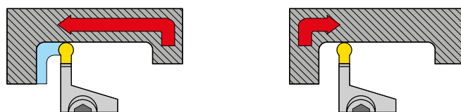
Dokončování zahloubení (VBD s kruhovým břitem) / Dokončovanie zahĺbenia (VRD s kruhovým britom)
